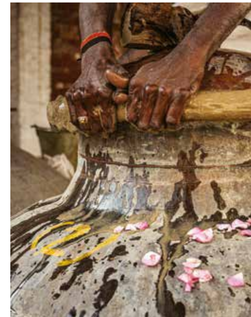
CI-DESSUS : fermeture du deg à l’aide d’un rondin d’argile
